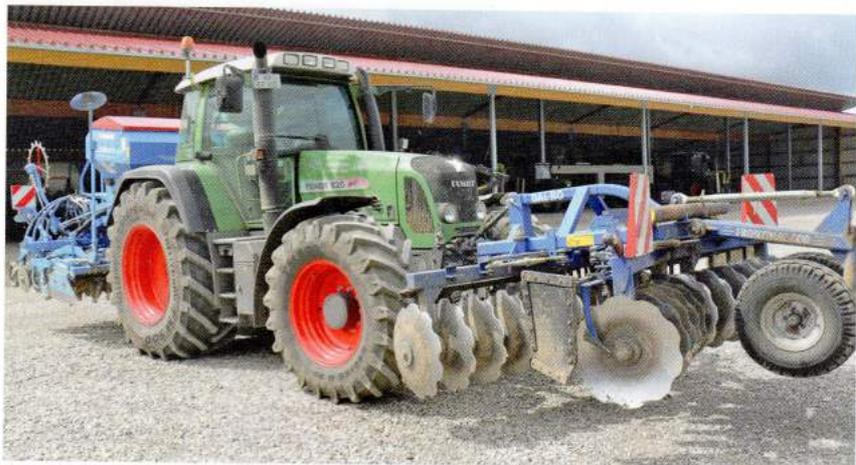
**Spart Arbeitszeit:** Mit einer Scheibenegge im Frontanbau und einer Kreiseleggen-Drillkombination im Heck erfolgt die Primärbodenbearbeitung zusammen mit der Saatbettbereitung und Saat. Eingesetzt wird das Gespann derzeit vor allem für den Zwischenfruchtanbau im Greening.
