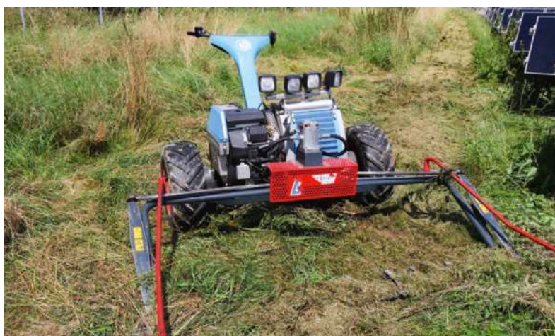
Spezialtechnik: Ein Motormäher mit Funksteuerung erweitert das Einsatzspektrum und sorgt für Sicherheit beim Anwender.
