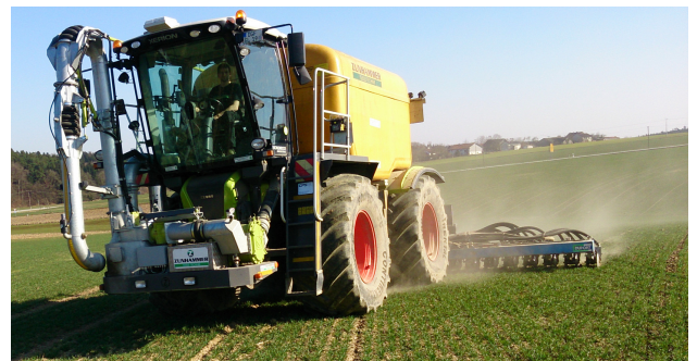
Claas Xerion mit 8 m Scheibeninjektor
